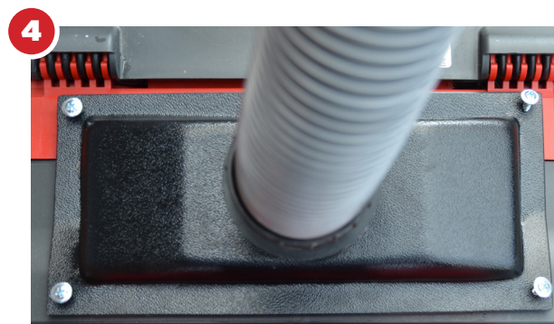
Slange monteres på udblæsningsstuds
